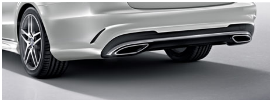
Kétcsövű kipufogórendszer, a lökhárítóba épített, négyzetes, krómozott kipufogó-végekkel.
