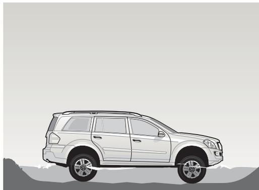
Steigfähigkeit bei geeigneten Bodenverhältnissen: bis zu 100 %.
