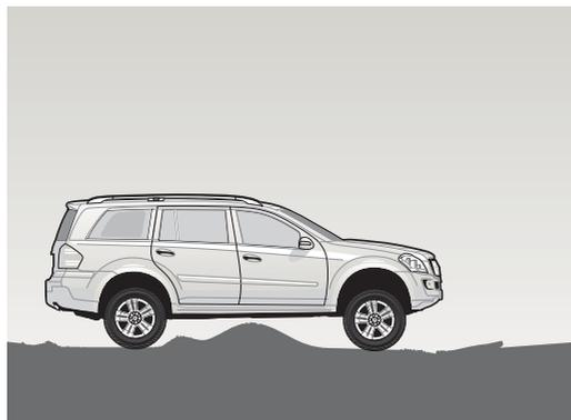
Böschungswinkel: bis zu 33° vorn und 27° hinten.
